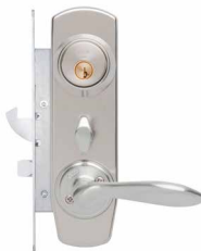
LÅSSATS ASSA Komplett med cylinder, behör och handtag. 3 st nycklar i serie. Cylinderpaket D1212. Handtag 1956 mattkrom. Låshus 2002 hakregel.
