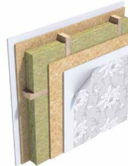
13 mm gips, 12 mm OSB, 45x70 mm träregel, 45 mm ljudisolering, 12 mm OSB, 13 mm gips.
